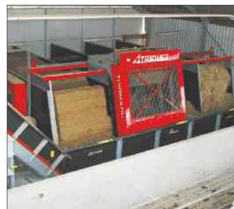
Tapis chaîne de chargement transversal et diagonal avec système de pesée.
