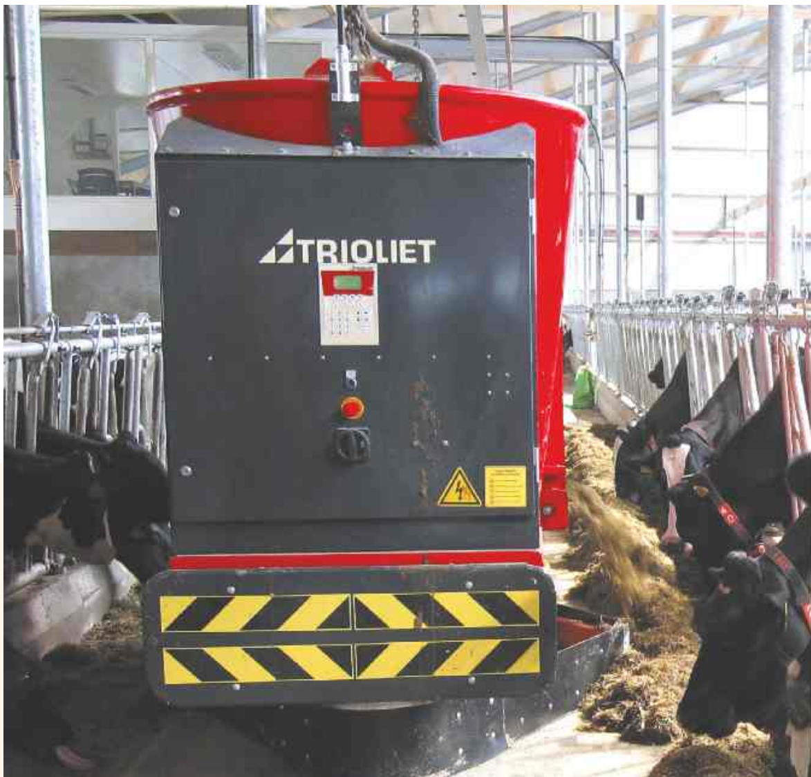
Mélangeuse-distributrice à double vis verticalisée, pendue en chaîne.
