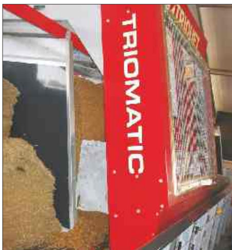
Console sur rail avec système de coupe à double lame avec rouleau démêleur. Réglage de l'épaisseur de tranche 5-35 cm.
