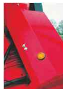
Une lampe témoin indique que l'ensilage est découpé jusque sur la pelleuseuse.
