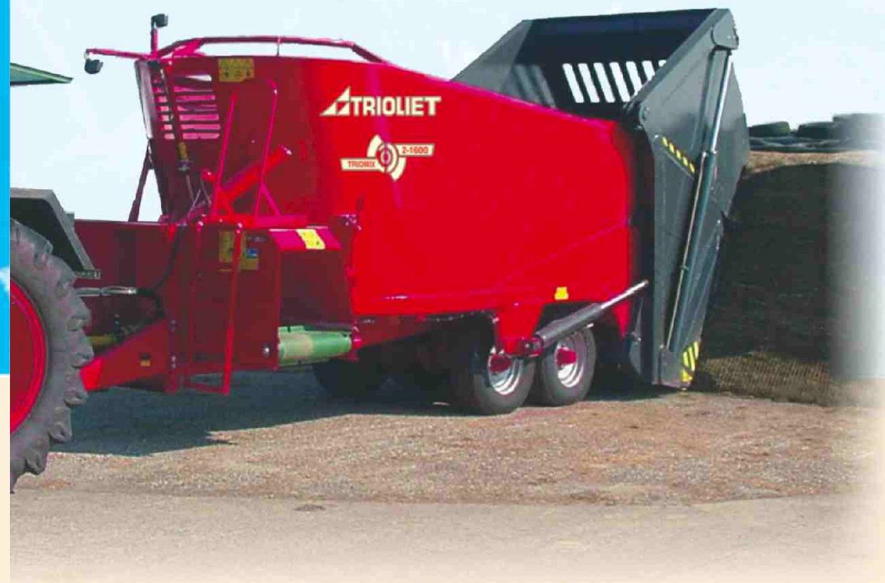
Les deux vis verticales à couteaux garantissent un mélange parfait avec maintien de la structure.
